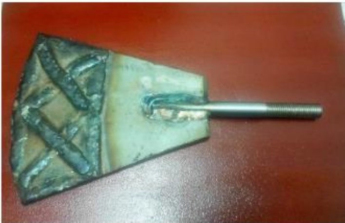
Paletas en acero Inoxidable. (Cromo 12). Cubierta de soldadura Eutetrode 5005.
