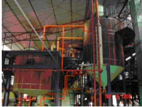
Foto 5. Agroince Ltda. Clarificador de recuperados de centrífuga
